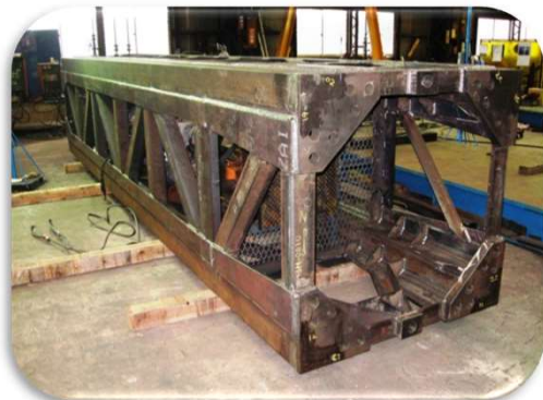
タワークレーン（マスト）
