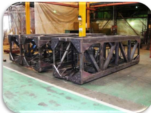
タワークレーン（マスト）
